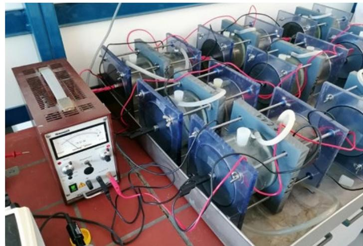
Zellenversuch zur Bewertung des Hydrolysewiderstands
